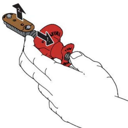
Obr. 80: Demontáž držáku tavné pojistky.
