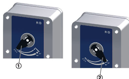
Obr. 20: Ukazatel polohy listu klapky
